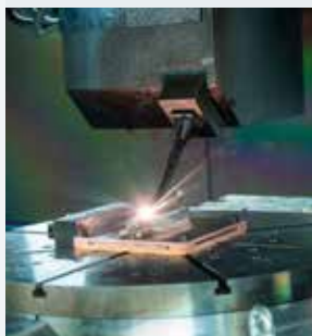
3D-printning med elektronstråle (EB) där materialtillförsel med tråd ger hög produktivitet.
