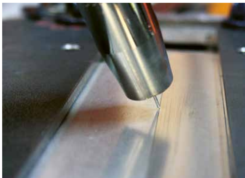
Stumfogning av stål (vänster) till aluminium (höger) med CMT advanced. Processen svetsar i aluminiumet och löder till stålet, därför kallas det svetslödning. Med uppställningen stumfog är processen extremt känslig för variationer.
